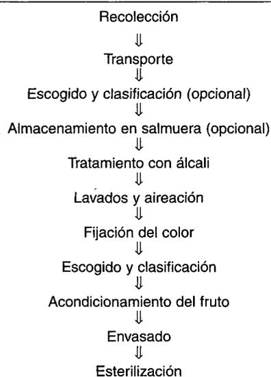
Figura 3. Esquema de la elaboración de aceitunas tipo negras
