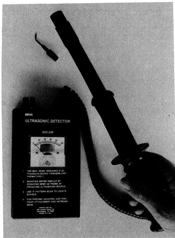
sido diseñado específicamente para hacer posible el uso del detector en un ambiente de trabajo, no registra los ruidos del ambiente producidos por maquinaria, motores, bombas, etc. El Detector es capaz de reconocer y avisar sobre una fuga producida a un metro de distancia del aparato, permitiendo al usuario, con una serie de acoplamientos, conocer la posición exacta de la pérdida, con lo que aquel la podrá marcar "in situ" para su eventual reparación o recambio.
